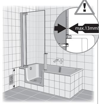
En cas de montage sur le mur fini, le profilé decompensation est nécessaire Le carrelage sera appliqué après montage de la baignoire. Le carrelage ne doit dépasser que de **maxi 13 mm** sur le bord de labaignoire. N'installer la baignoire que sur un sol complètement carrelé et terminé. Par contre les murs doivent rester nus.
